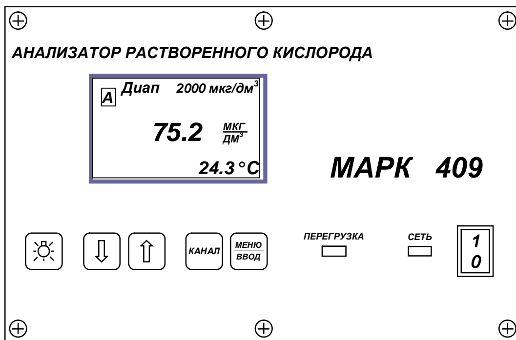
Рисунок 1.1 – Расположение органов управления и индикации на передней панели блока преобразовательного
