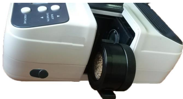
Рисунок 4 – Установка кюветы в анализатор
